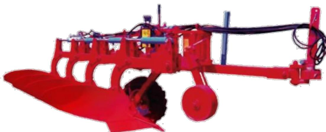
I semi-portati si sollevano e si abbassano sfruttando il sollevatore della trattrice e la ruota di profondità e di trasporto. Grazie alla ruota di trasporto viene assorbita la pressione laterale, consentendo una lavorazione con facile traino ed usura ridotta; prestazioni del trattore ed aratura sempre ottimali; l'aratro segue perfettamente la carreggiata del trattore; su strada l'aratro viene girato in posizione centrale, garantendo la massima sicurezza durante il trasporto.
