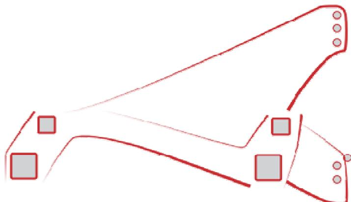
I Coltivatori **WINNER** sono dotati di telaio multiplo che conferisce solidità al telaio. Costituito da profilati paralleli, ad altoresistenziale, distribuiti in due livelli permettono di aumentare la resistenza della struttura creando un effetto “trave”. La posizione dei profilati è studiata in modo da conciliare le migliori prestazioni al design unico di questo attrezzo. Le lamiere ortogonali tengono ben salda la struttura.
