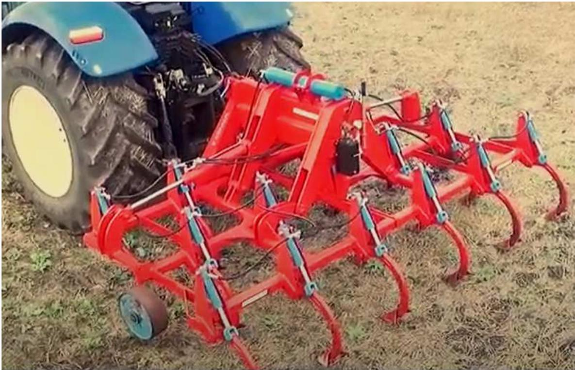
Le ancore sono realizzate con acciai speciali ad altoresistenziale, per le spiccate caratteristiche antiusura, unite a doti di durezza e tenacità, con valori tipici di carico di snervamento e di rottura di livello estremamente alto.
